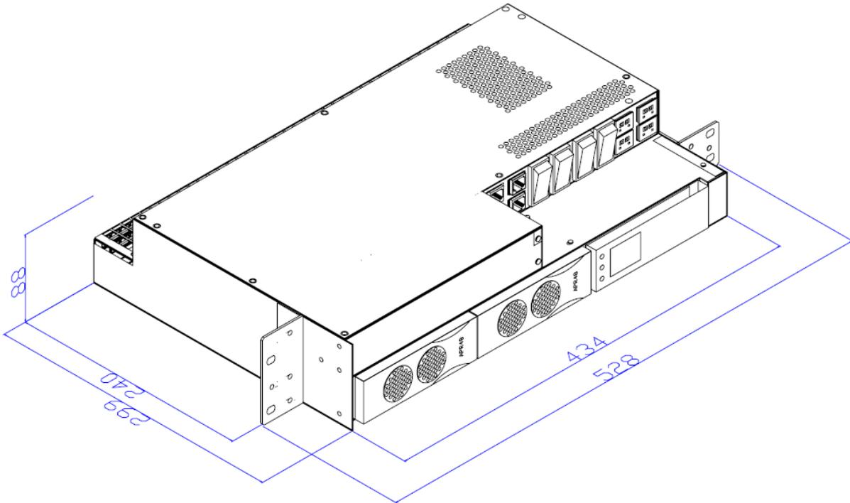
Einbautiefe mit Berücksichtigung der Kabel und Gegenstecker sowie der rückseitigen Belüftung beträgt 300mm. Frontseitig sind min. 20mm Freiraum zur Luftansaugung vorzusehen
